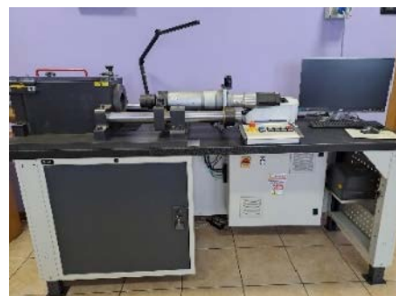
Banco prova coppia tensione – Torque test bench
